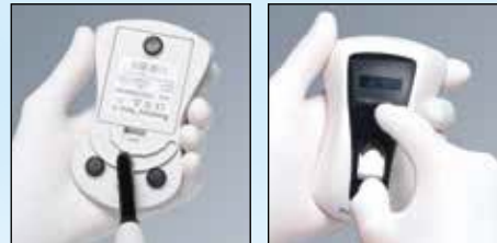
El diámetro de los conductos de luz se miden a través de una embocadura en la parte inferior del radiometer.
